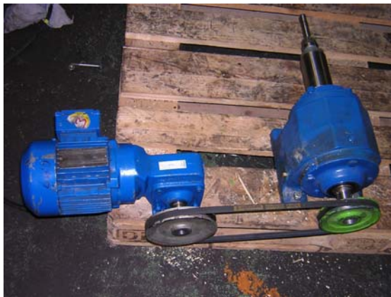
Versuchsaufbau: Motor 3 mit Belastungsspindel
